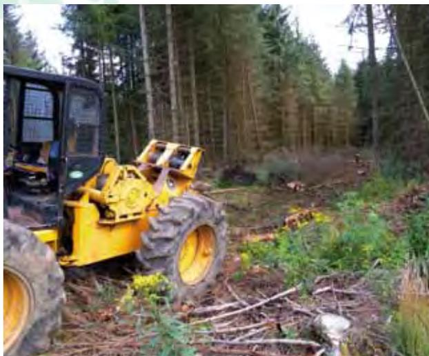
Opération de câblage des arbres par le skidder positionné en bord de zone humide ■ Aline Corbeaux
